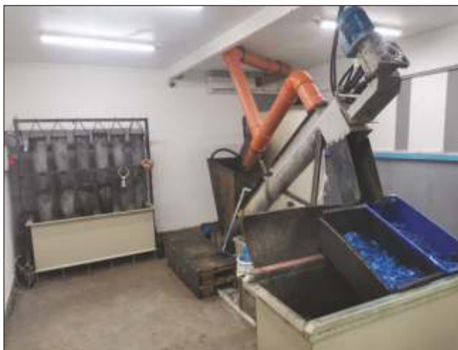
■ 5. kép. Röntgenfilm-feldolgozás során alkalmazott technológia pilot-plan modellje
