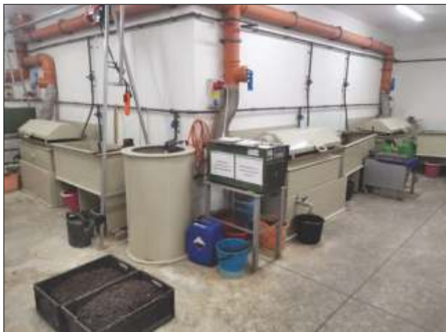
■ 3. kép. Nemesfém bevonat visszanyerésére alkalmas elektrokémiai rendszer
